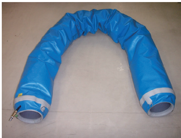
写真-2 本管用加圧チューブ（補修長5m）
